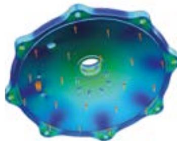
Simulación por ordenador del comportamiento de una tapa a las cargas de trabajo
